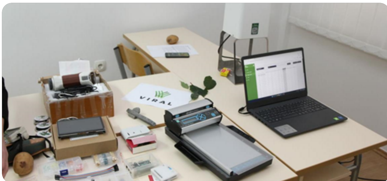
Slika 1. S lijeva na desno: raspberry pi kompleti, leafmetar – uređaj za mjerenje površine lista (skener lisne površine), prijenosno računalo i ekoNet uređaj koji mjeri kvalitetu zraka. Uređaj ekoNet spojen je na prijenosno računalo te se u stvarnom vremenu prikazuju parametri kvalitete zraka.
