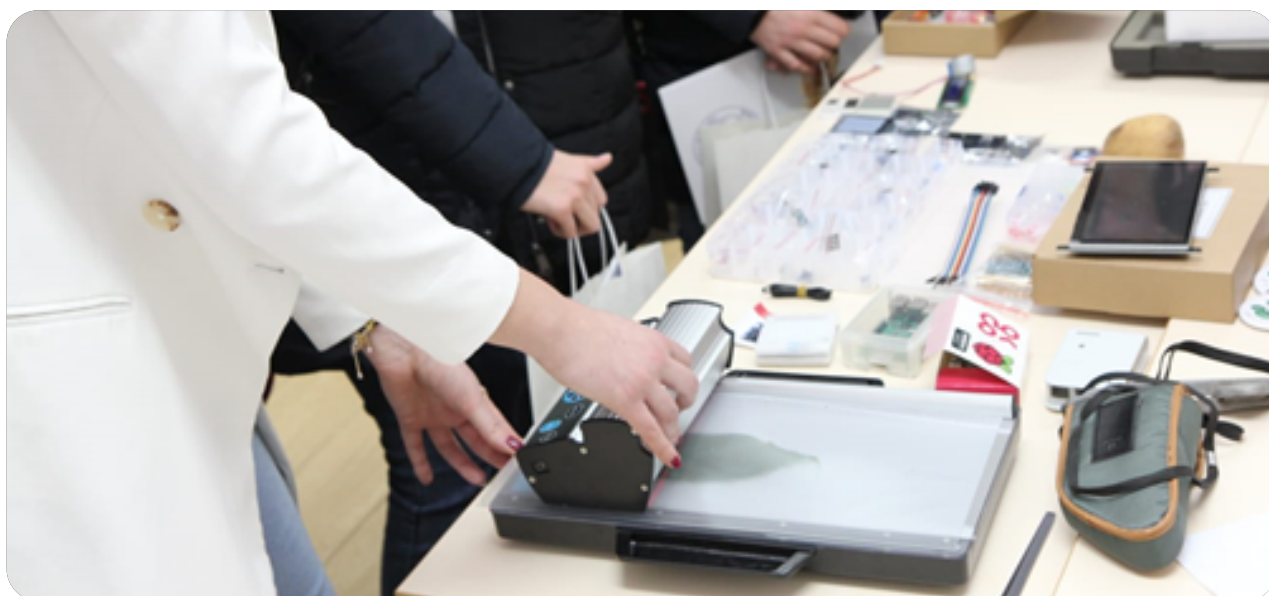
Slika 2. Prikaz rada skenera lisne površine. Skener se može koristiti u kombinaciji s drugim uređajima za brzo dijagnosticiranje opskrbljenosti biljke hranivima. Na slici je prikazan i uređaj za mjerenje dušika u biljnom soku.
